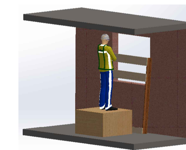
DETALHE M GUARDA CORPO PARA JANELAS
