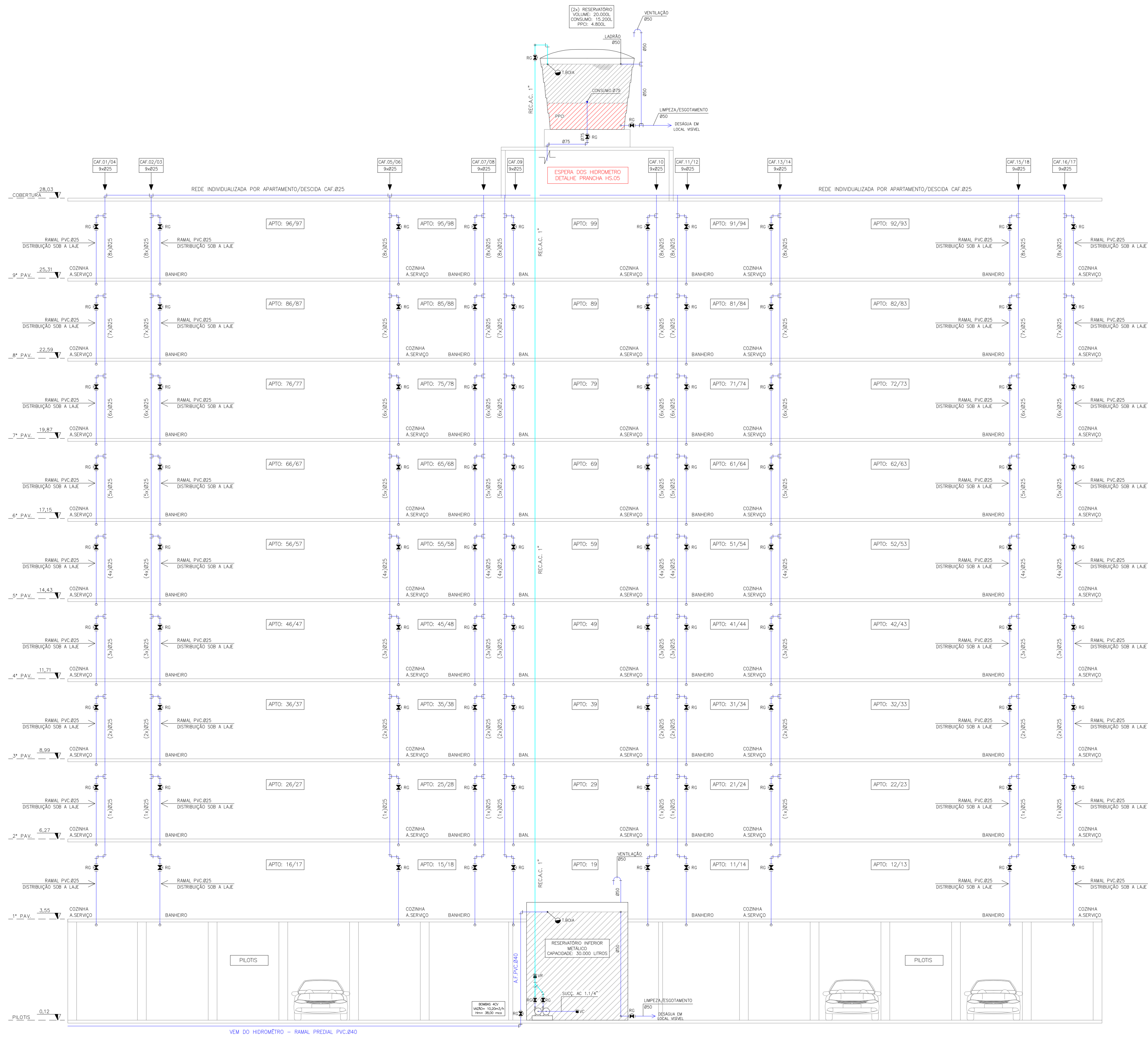
CORTE ESQUEMÁTICO LONGITUDINAL ABASTECIMENTO ÁGUA FRIA
