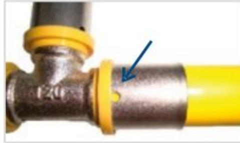
Insira o tubo na conexão até que ele esteja visível no furo de inspeção.
