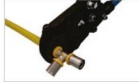
Posicione os berços adequados na ferramenta e, com ela, pressione o anel.
